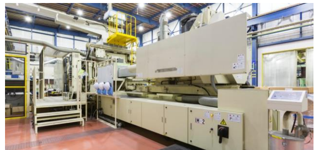
試作用 1300t 射出成型機(写真③)
