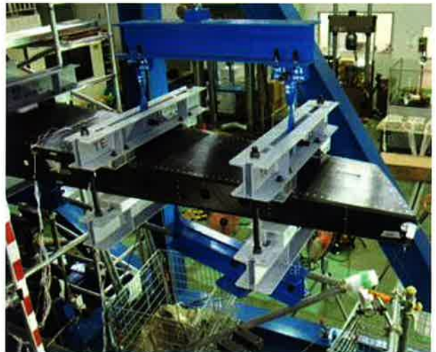
図18 JAXAによる実大垂直尾翼桁間構造強度試験
