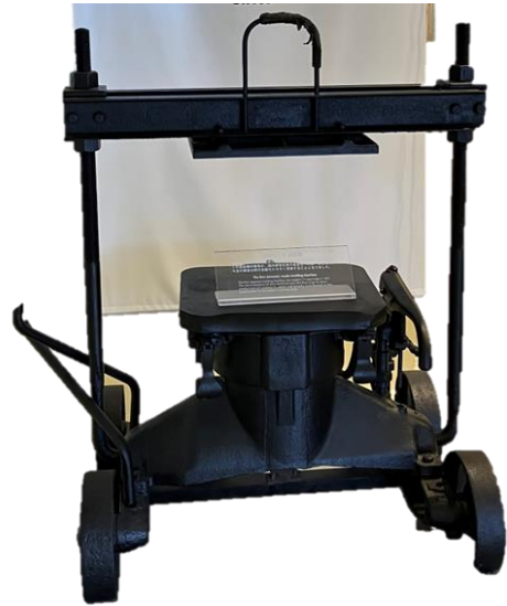
図2 C-11型造型機(弊社豊川製作所内にて)
