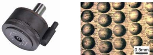
写真3 ディンプル成形ツールと加工面
