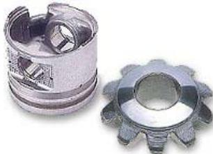
写真2 スパロールの加工ワーク事例
