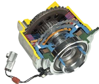
電子制御 4WD カップリングのカットモデル
