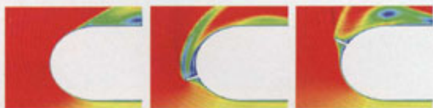
Fig.1: タブ位置とデルタ翼前縁剥離渦の生成関係
