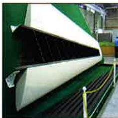
図17 実大垂直尾翼桁間工作性確認試験
