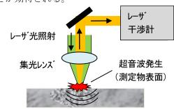
Fig.1 レーザ超音波法
