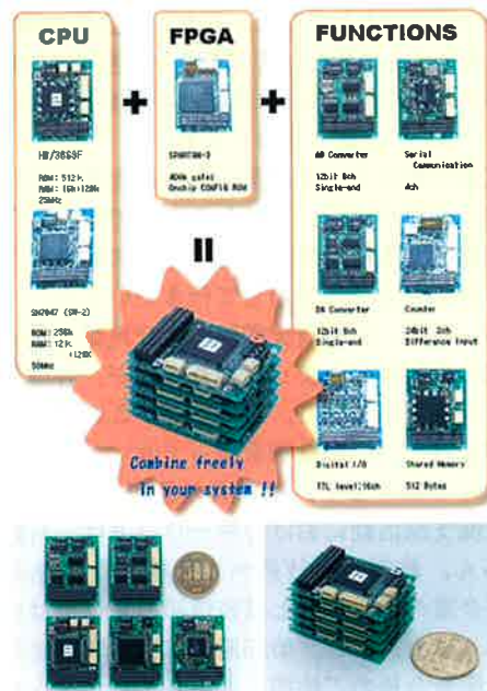
図2. ロボットRI-MANの超小型汎用計測制御装置
